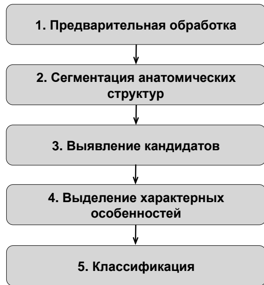
Рис. 1. Последовательность работы систем КАД при анализе медицинских изображений.
