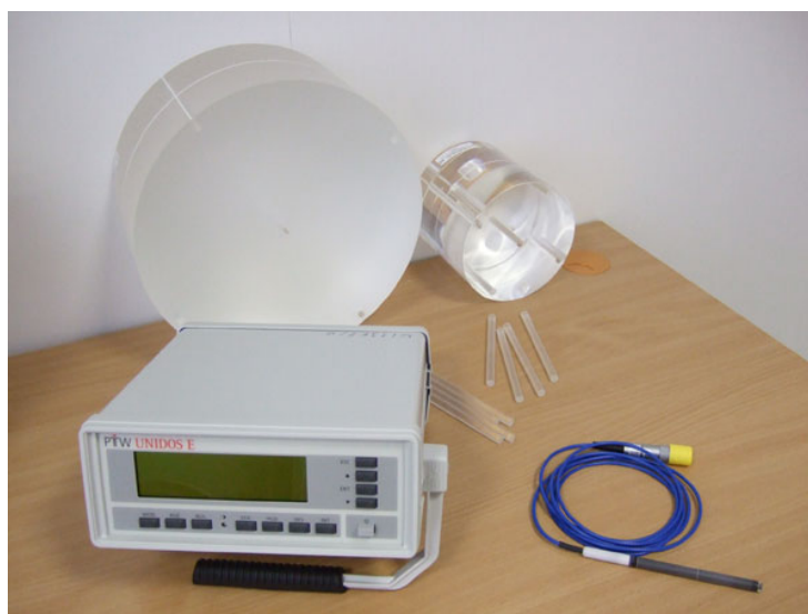
Рис. 1. Комплект оборудования для измерения доз облучения при КТ-исследованиях: фантомы для головы и туловища, дозиметр, ионизационная камера (PTW Freiburg, Германия)
