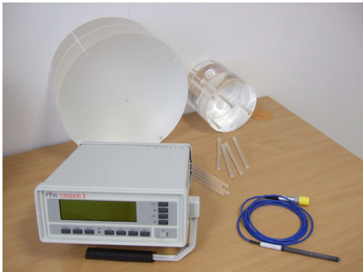
Рис. 1. Комплект оборудования для измерения доз облучения при КТ-исследованиях: фантомы для головы и туловища, дозиметр, ионизационная камера (PTW Freiburg, Германия).
