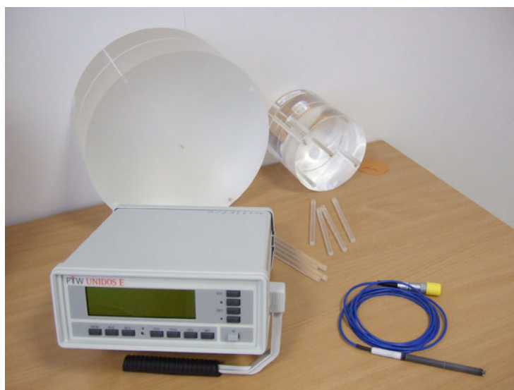
Рис. 1. Комплект дозиметрического оборудования для измерения компьютерно-томографического индекса дозы: фантомы для головы и туловища, дозиметр, ионизационная камера.
